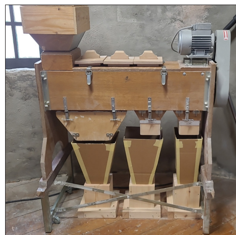
De buil op de steenzolder, met de kartonnen trechters naar de pijpen eronder
