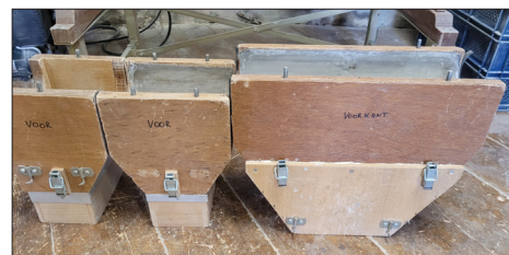
De drie zeefbakken, van rechts naar links voor bloem, griesen en zemelen
