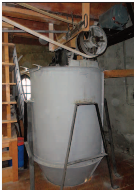
De mengketel op de 2e zolder
